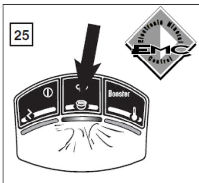
**EMC (Electronic Mineral Control)** – система электронного мониторинга жесткости воды, которая контролирует эффективность работы антиминерального картриджа, постоянно определяя жесткость отфильтрованной воды. Таким образом, система EMC снижает риск образования минерального осадка в вашем приборе.
